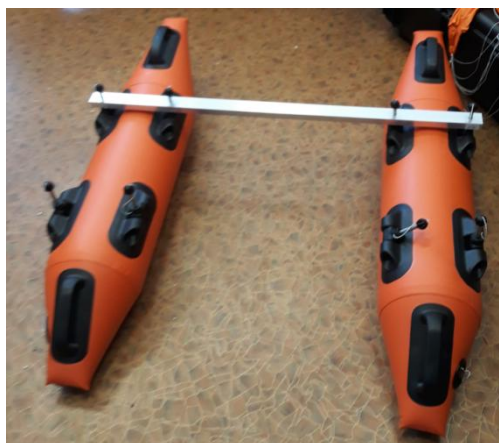
Рис. 2. Надувные баллоны катамарана и их соединение с балкой
