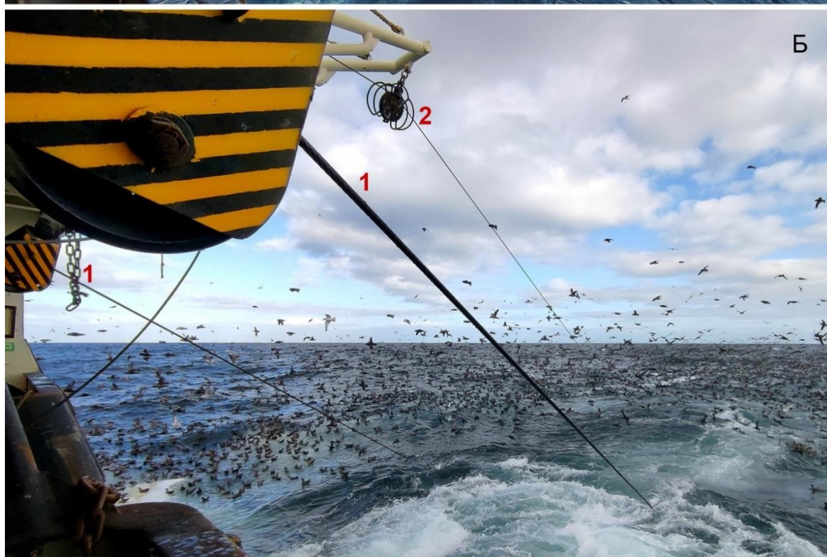
Расположение ваеров (1) и кабеля прибора контроля трала (2) при использовании основной (А) и резервной (Б) лебедок ИГЭК на СРТМ «Мыс Муравьева»
